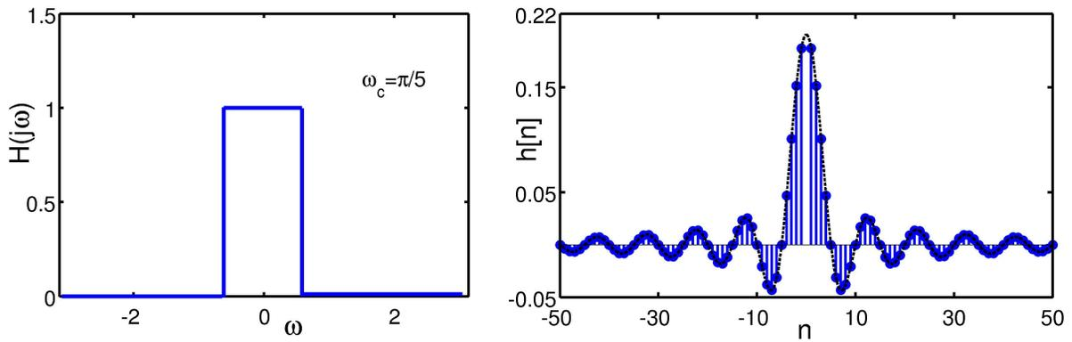
**Figura 10:** Respuesta en frecuencia (a) y respuesta al impulso (b) de un filtro pasa bajos discreto para  $\omega_c = \pi/5$ . Con color rojo se grafica la envolvente de  $h[n]$ .
