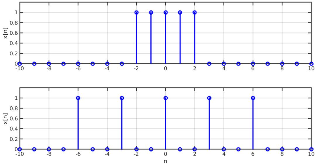
**Figura 7:** Señal obtenida a partir de una expansión temporal en tiempo discreto  $x_3[n]$ .
