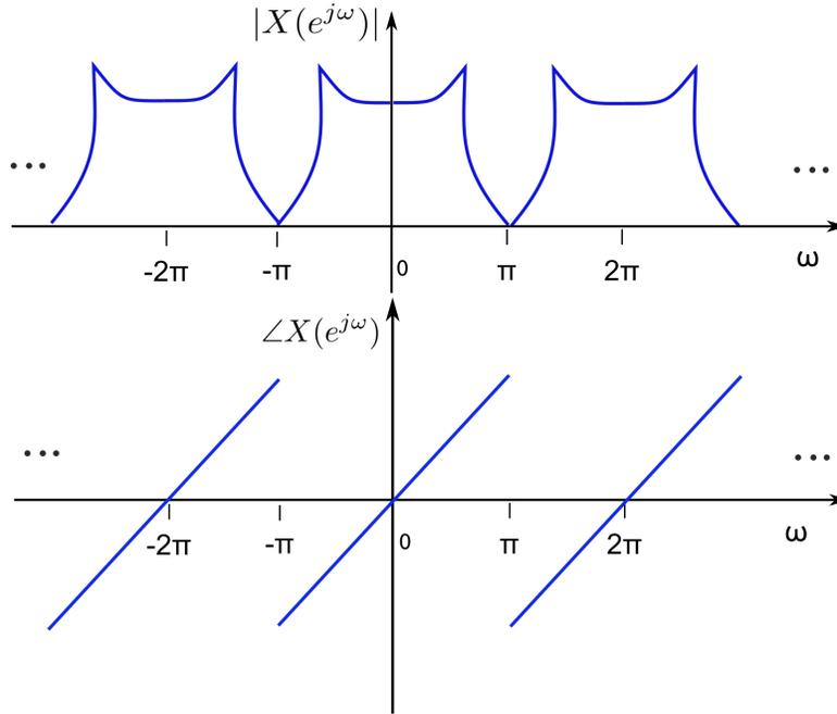
**Figura 9:** Espectro de una señal real (ejemplo 10).
