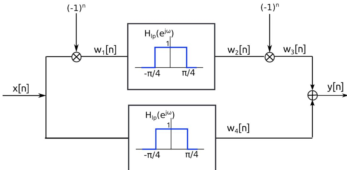
**Figura 11:** Filtro supresor de banda discreto descrito en el ejemplo ??.
