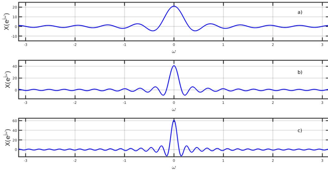
**Figura 6:** Transformada pulso cuadrado discreto definido en el ejemplo 7, para  $N_1 = 10$  (a),  $N_1 = 20$  (b) y  $N_1 = 30$  (c).
