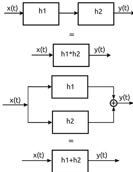
**Figura 8:** Propiedades de la operación convolución aplicadas a la respuesta al impulso de la interconexión de sistemas
