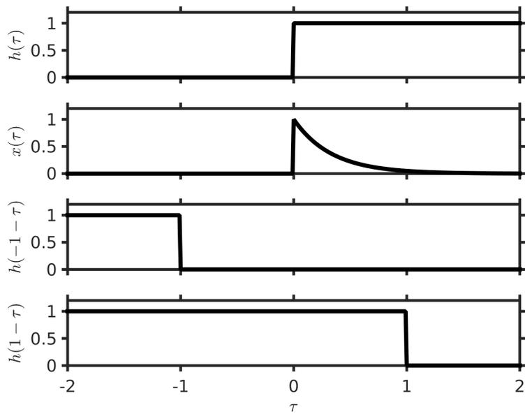
**Figura 6:** Cálculo gráfico de la convolución descrito en el ejemplo 10: a)  $h(\tau) = u(\tau)$ , b)  $x(\tau) = e^{-a\tau}$ , c)  $h(-1 - \tau)$  (desplazamiento de  $h$  para  $\tau < 0$ , d)  $h(1 - \tau)$  (desplazamiento de  $h$  para  $\tau > 0$ )
