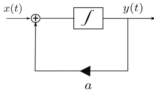
**Figura 11:** Diagrama de bloques de sistemas continuos: el integrador en remplazo del diferenciador.
