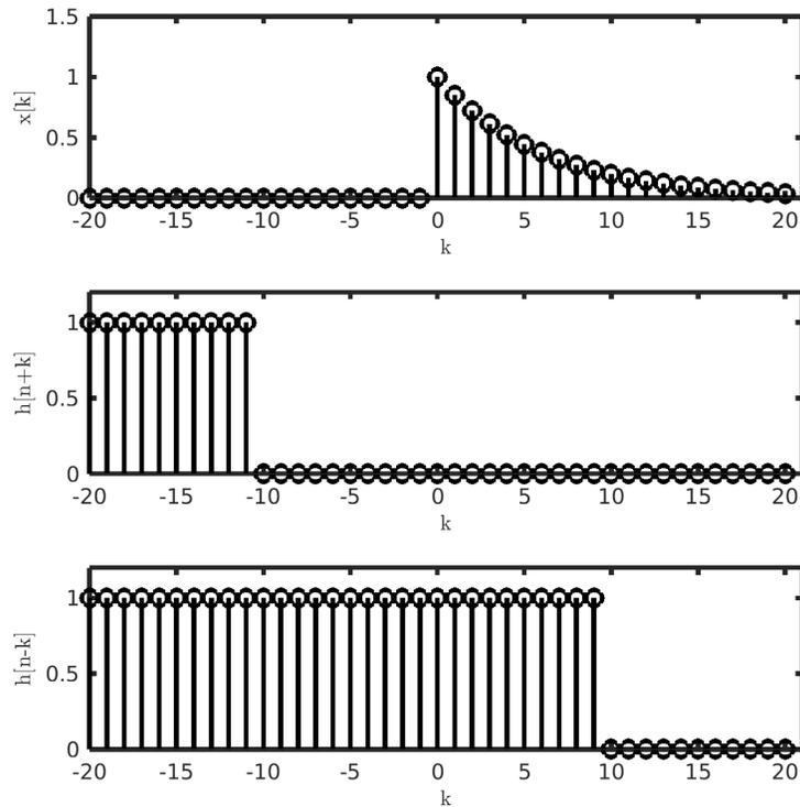
**Figura 3:** Desplazamiento de  $h[k]$  para obtener la convolución de forma gráfica.
