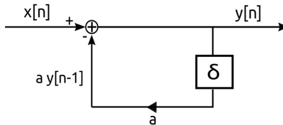
**Figura 9:** Diagrama de bloques que representa el sistema  $y[n] + ay[n - 1] = x[n]$
