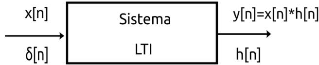
**Figura 1:** Respuesta de un LTI discreto obtenida mediante la convolución
