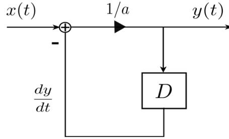
**Figura 10:** Diagrama de bloques de sistemas continuos del sistema  $\frac{dy(t)}{dt} + ay(t) = x(t)$
