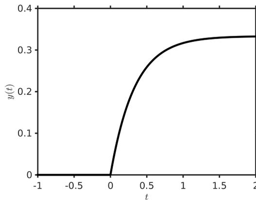
**Figura 7:** Solución del ejemplo N<sup>o</sup> 5,  $y(t) = 1/a (1 - e^{-at}) u(t)$ .
