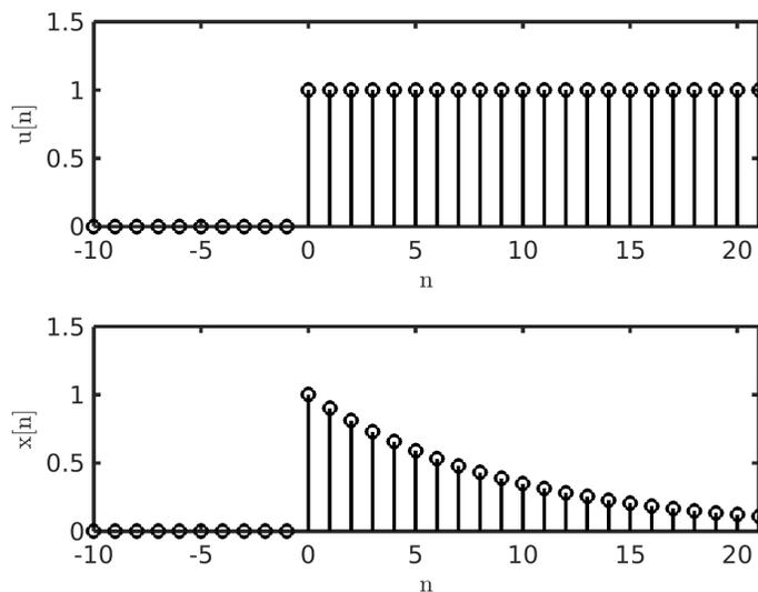
**Figura 2:** Señal y respuesta al impulso del sistema descrito en Ejemplo N° 5
