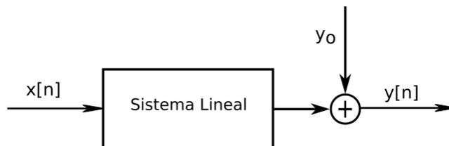
**Figura 26:** Representación de un sistema incrementalmente lineal
