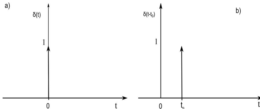
**Figura 16:** Esquemas de la señal impulso unidad (a) y su versión desplazada en el tiempo (b)
