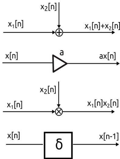
**Figura 19:** Bloques que representan las operaciones básicas de procesamiento de señales discretas
