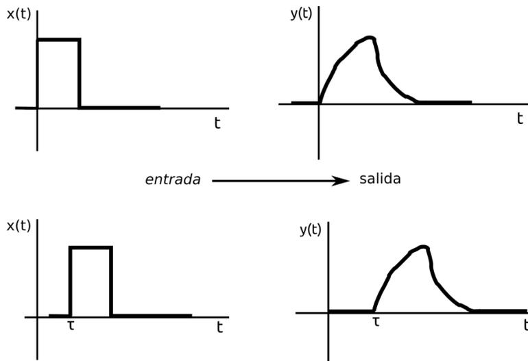
Figura 24: Respuesta de un sistema invariante con el tiempo.
