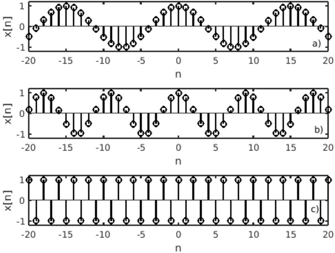
**Figura 10:** Gráfica de la señal  $x[n] = \cos(\omega n)$ , para a)  $\omega = 0,1333 \pi$ , b)  $\omega = 0,222 \pi$  y c)  $\omega = \pi$ .
