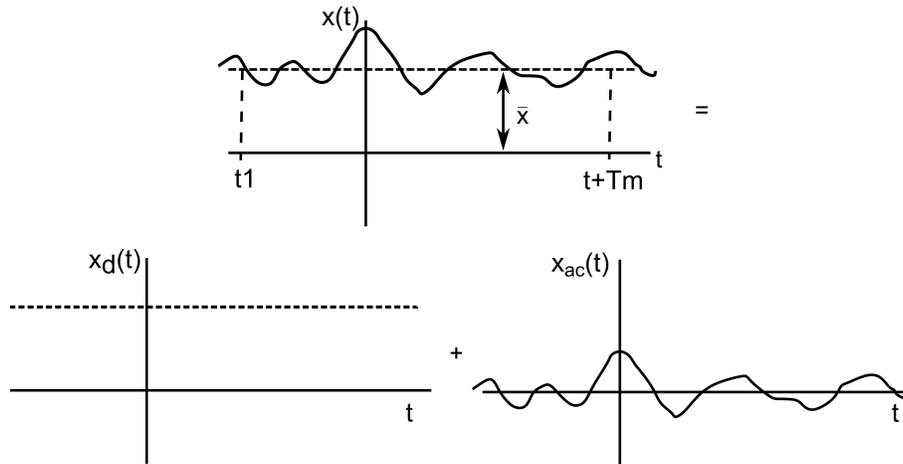
**Figura 8:** Representación de una señal como la sumas de sus componentes directa y alterna:  $x(t) = x_d(t) + x_{ac}(t)$
