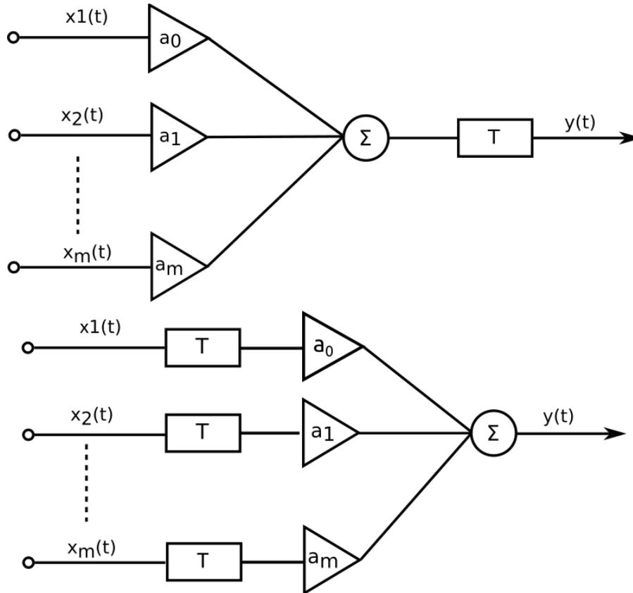
Figura 25: Conmutación de sistemas lineales
