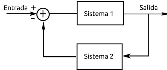
**Figura 21:** Interconexión de sistemas en una configuración con realimentación.
