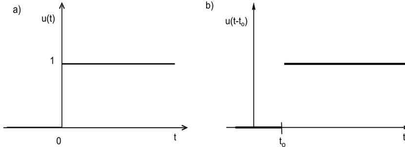
**Figura 14:** a) Señal escalón unidad b) Señal escalón unidad desplazada.
