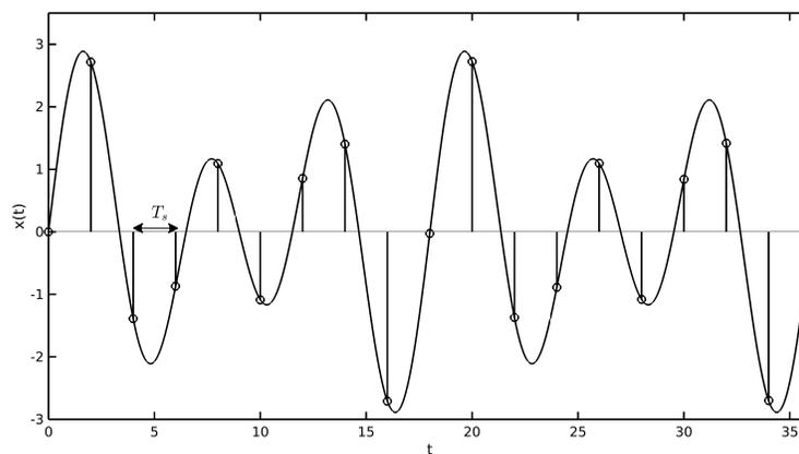
**Figura 3:** Esquema del proceso de muestreo de una señal continua: señal continua muestreada con  $T_s = 2$ .
