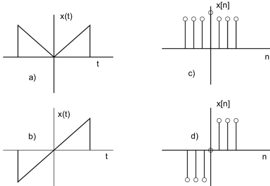
**Figura 6:** Ejemplo de señales pares (a y c) e impares (b y d)
