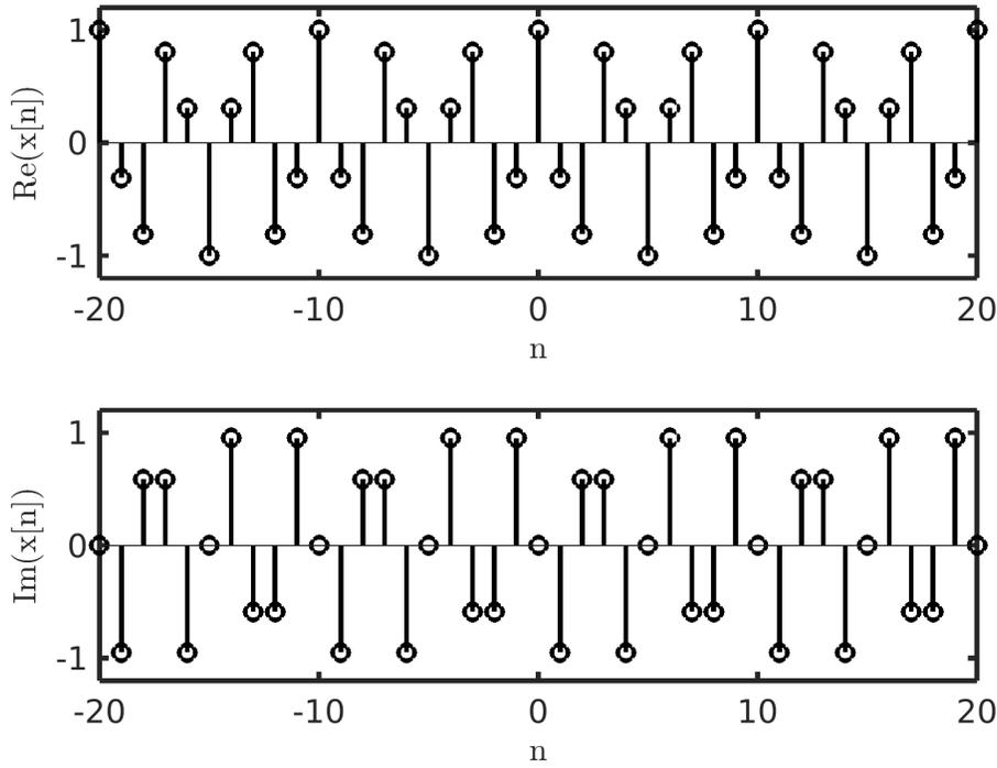
**Figura 9:** Gráfica de la parte real (a) y parte imaginaria (b) de la señal  $x[n] = e^{3\pi/5 n}$ .
