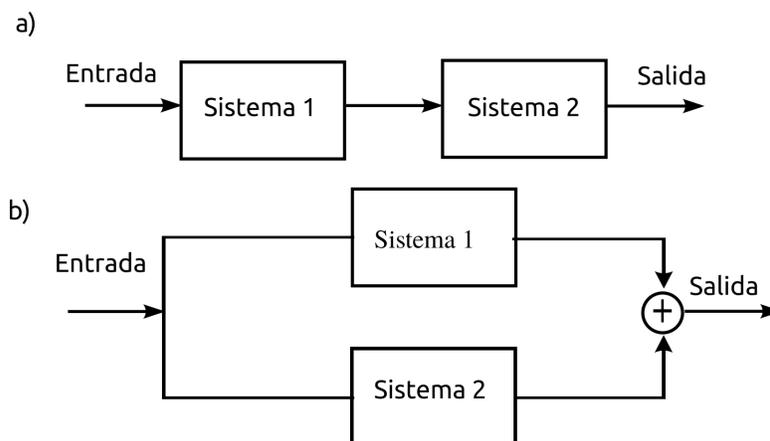
**Figura 20:** Interconexión de sistemas en serie (a) y en paralelo (b)
