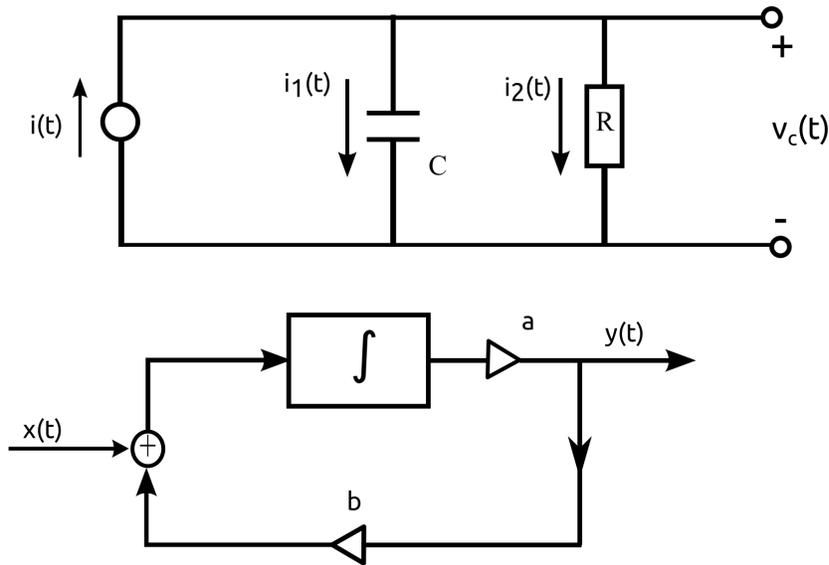
**Figura 22:** Implementación de un circuito RC como un sistema realimentado,  $a = 1/C$  y  $b = 1/R$ .
