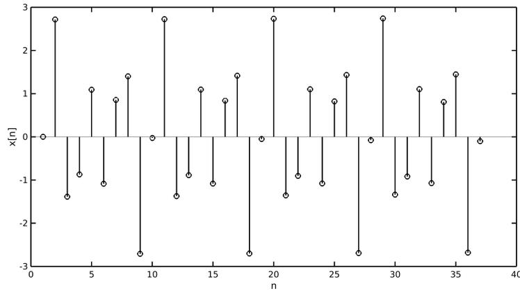
**Figura 4:** Esquema del proceso de muestreo de una señal continua: señal discreta obtenida por el muestreo de la señal mostrada en la figura 3
