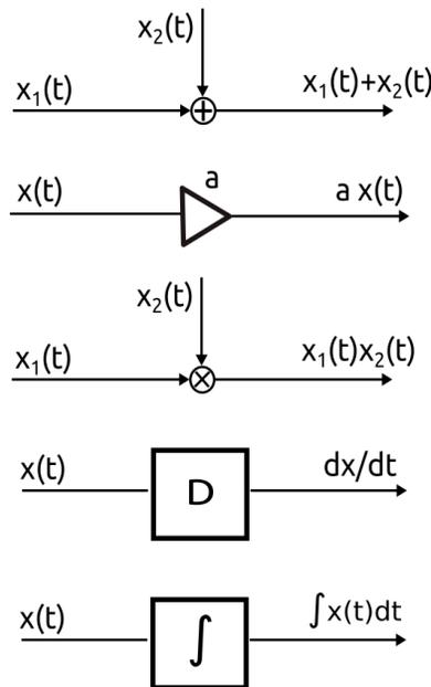
**Figura 18:** Bloques que representan las operaciones básicas de procesamiento de señales continuas
