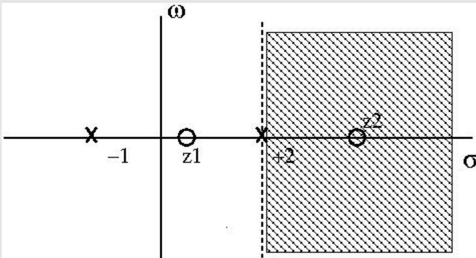
$$X(s) = \frac{b_o (s - z_1)(s - z_2)\dots(s - z_m)}{a_o (s - p_1)(s - p_2)\dots(s - p_n)}$$
