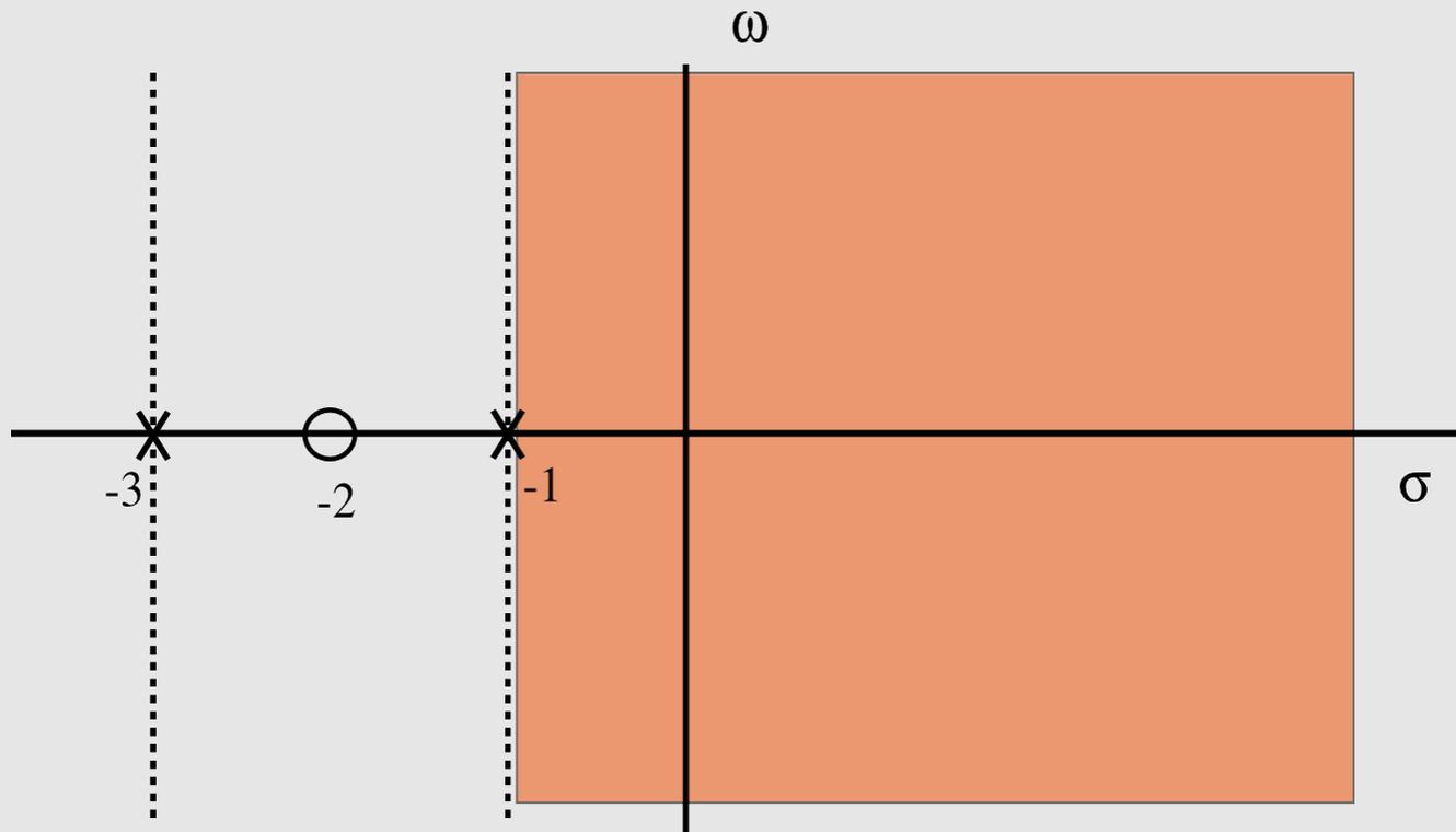
$$X(s) = \frac{b_o (s - z_1)(s - z_2)\dots(s - z_m)}{a_o (s - p_1)(s - p_2)\dots(s - p_n)}$$
