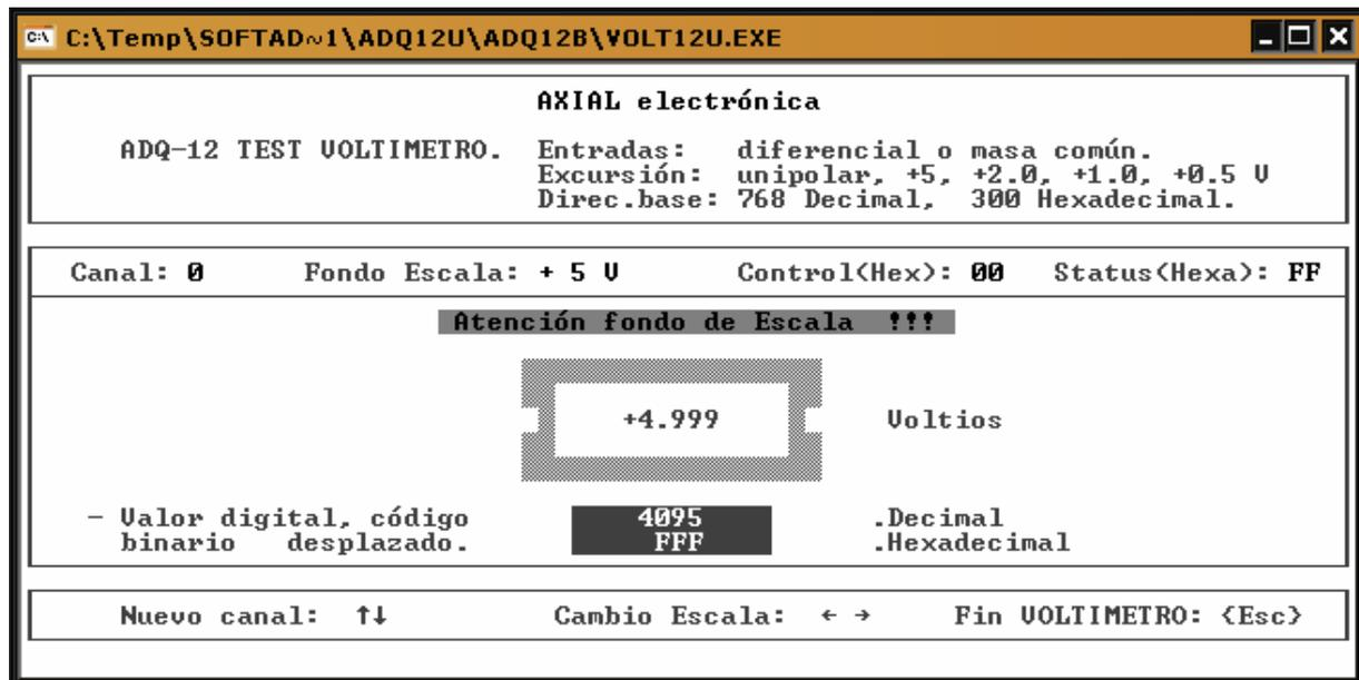
6.1.5 Verifique todos los canales de la placa. Para cambiar de canal de entrada utilice los cursores [←] [→]. Para cambiar la escala utilice los cursores [↶] [↷]. El fondo de escala se debe ajustar a 5V.
