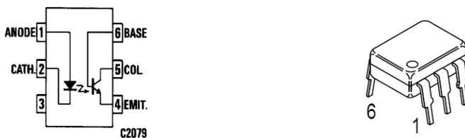
Figura 7. Opto-acoplador 4N35 y su respectivo encapsulado.
