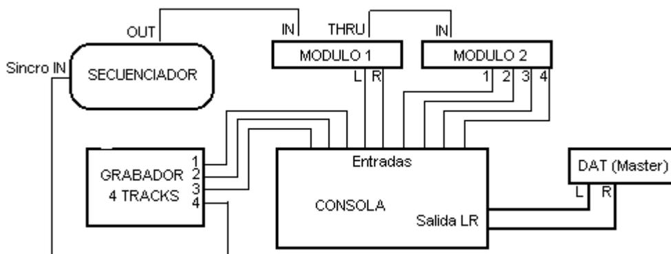
Ejemplo de una grabación con sincronismo en un grabador de 4 canales. Uno de los canales del grabador se usa para la señal sincro. El módulo 1 tiene 2 salidas de audio y el 2 tiene 4. Estas 6 salidas NO pasan por el grabador, son canales virtuales. Los 3 canales restantes del grabador van a la consola y se mezclan con los otros 6 hacia el DAT.
