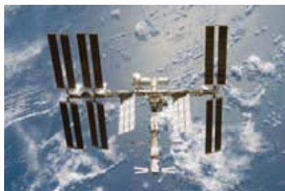
Estación Espacial Internacional Distancia al centro de la Tierra = 6800 km (400 km arriba de la superficie) Rapidez orbital = 7.7 km/s Periodo orbital = 93 min
