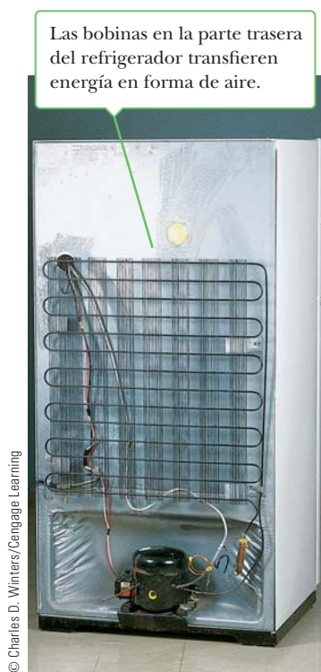
Figura 12.15 Parte trasera de un refrigerador doméstico. El aire que rodea las bobinas es el depósito caliente.
