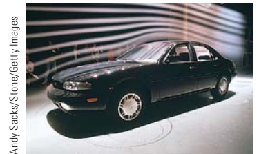
Figura 9.27 Una ilustración de las líneas de corriente alrededor de un automóvil en una prueba en un túnel de viento. Las líneas de corriente en el flujo de aire se hacen visibles con partículas de humo.
