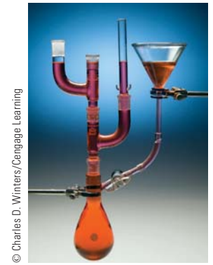
Figura 9.13 Esta fotografía ilustra el hecho de que la presión en un líquido es la misma en todos los puntos con la misma elevación. Observe que la forma del recipiente no afecta la presión.
