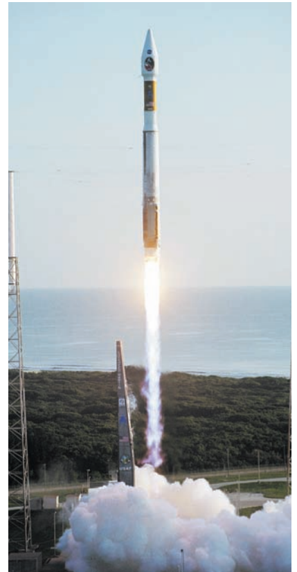
8.34 Con la finalidad de dar suficiente empuje para elevar su carga en el espacio, el vehículo de lanzamiento Atlas V expelle más de 1000 kg de combustible quemado por segundo con una rapidez de casi 4000 m/s.
