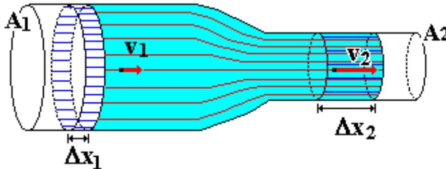
El caudal  $Q_1$  a la entrada de la tubería debe ser el mismo que el caudal  $Q_2$  a la salida de la tubería.
